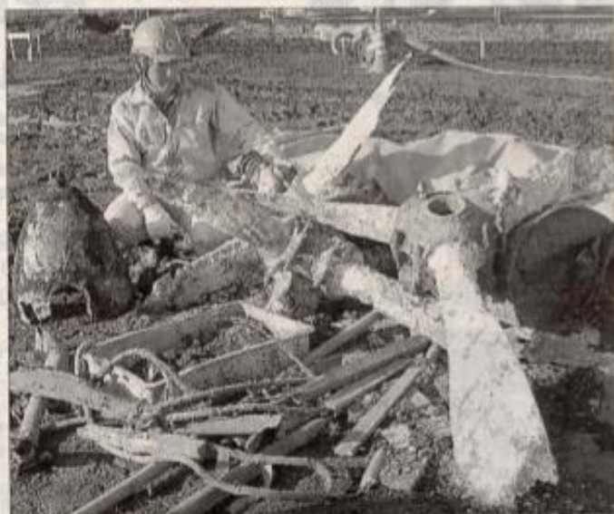
見つかった「飛燕」などの軍用機のプロペラ。左端の筒状部品は五式戦闘機の頭の部分＝調布市西町
